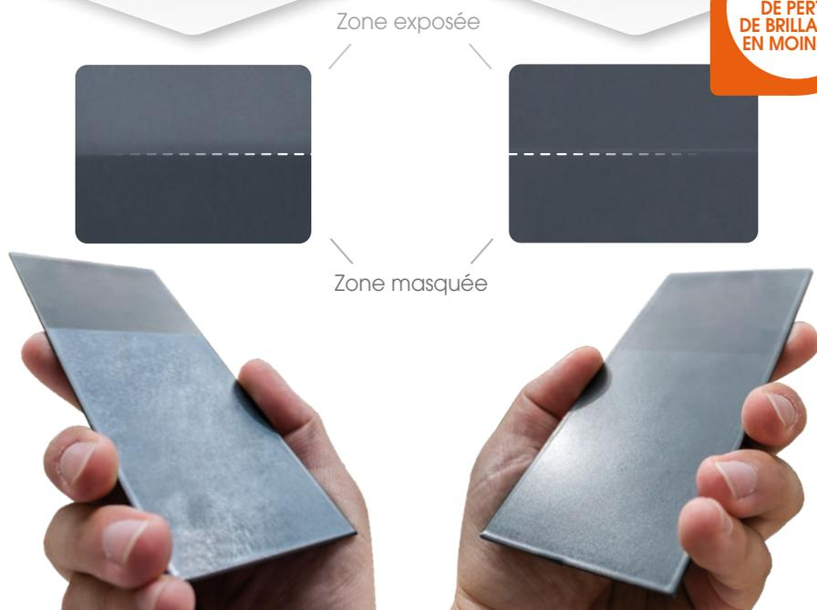
\*Test QUVB 313 (norme 4892-3). L'enceinte de vieillissement accéléré, reproduit artificiellement le spectre solaire complet. Elle simule, en quelques heures ou semaines, les détériorations et les dommages provoqués par l'irradiation solaire et les intempéries en extérieur sur plusieurs années - \*\* Par rapport à la perte de brillance d'un laquage Qualicoat Classe 1
